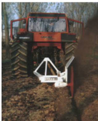
ROD típusú vertikális árokmaró
