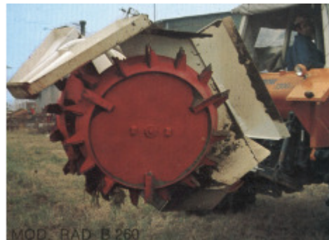
RAD B típusú két marókerekes árokásók
