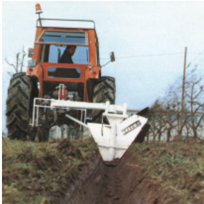
BIL típusú, egy marókerekes kétoldala állítható árokásó
